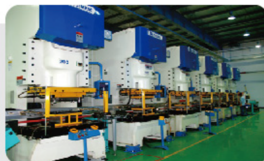
SHUTTLE LINE 200 TON 7台 1 LINE -MNT 24 inch 以下 CB,PB,NBPC CT
